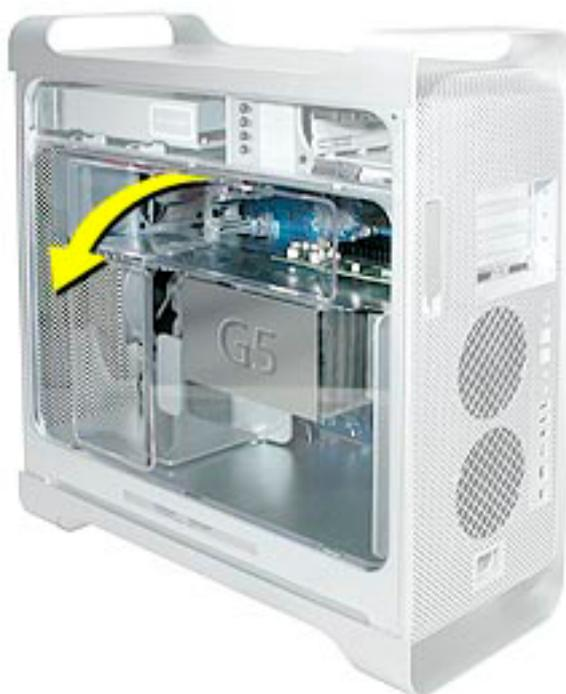
2. ディフレクターの下端にある3つのタブをケースの下部フレームにある3つのスロットに差し込んで、交換用のエア・ディフレクターを取り付けてください。次にディフレクターを持ち上げて上部フレームとそろえます。
