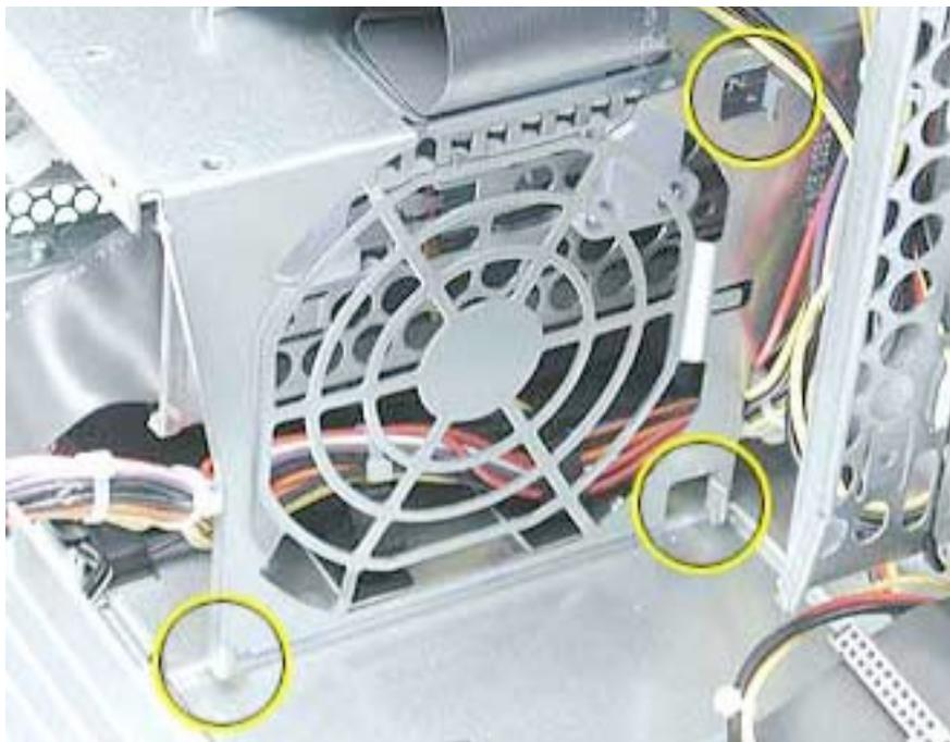
**【取付けの参考】** 下図のように、ファンケーブルはリボンケーブルの下、細いフレキシブルケーブルの上を通します。(図14)
