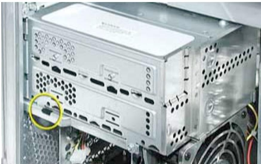
**【取付けの参考】** キャリアのリアパネルを取り付ける前に、リアパネル上部のヘリとキャリア上端がはまるようにして下さい。
