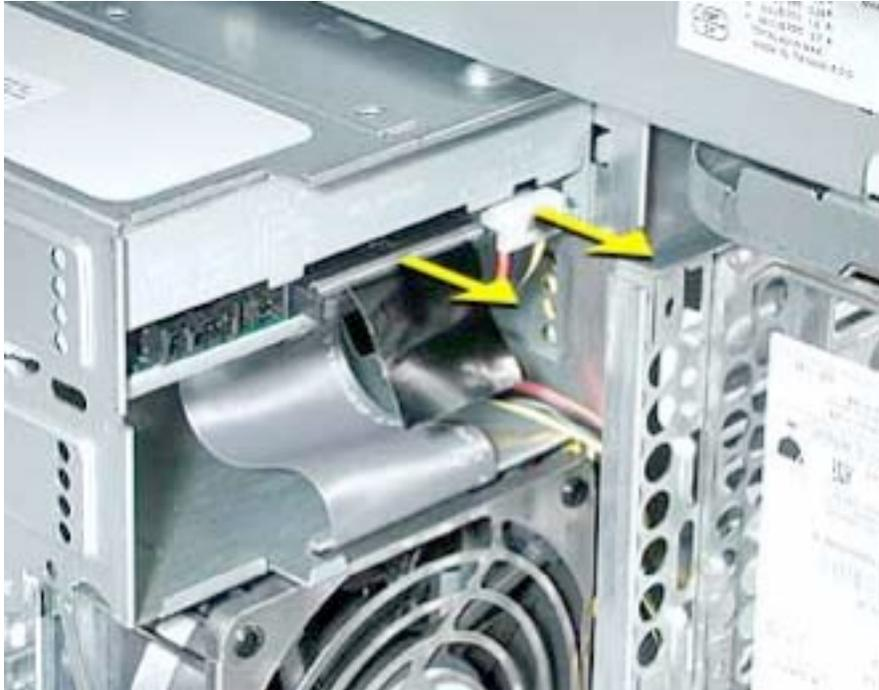
5. リボンケーブルをロジックボードから外して、下にあるファンケーブルが見えるようにします。（図5）
