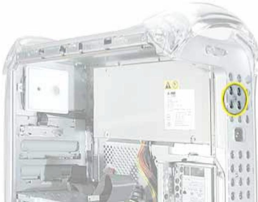
9. サイドパネルのネジ (+) を外します。(図9)
